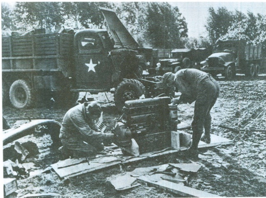
In een voertuigdepot in Normandië wordt een Type 270 motor uit zijn verpakking gehaald om vervolgens in de GMC op de achtergrond te worden gemonteerd.
